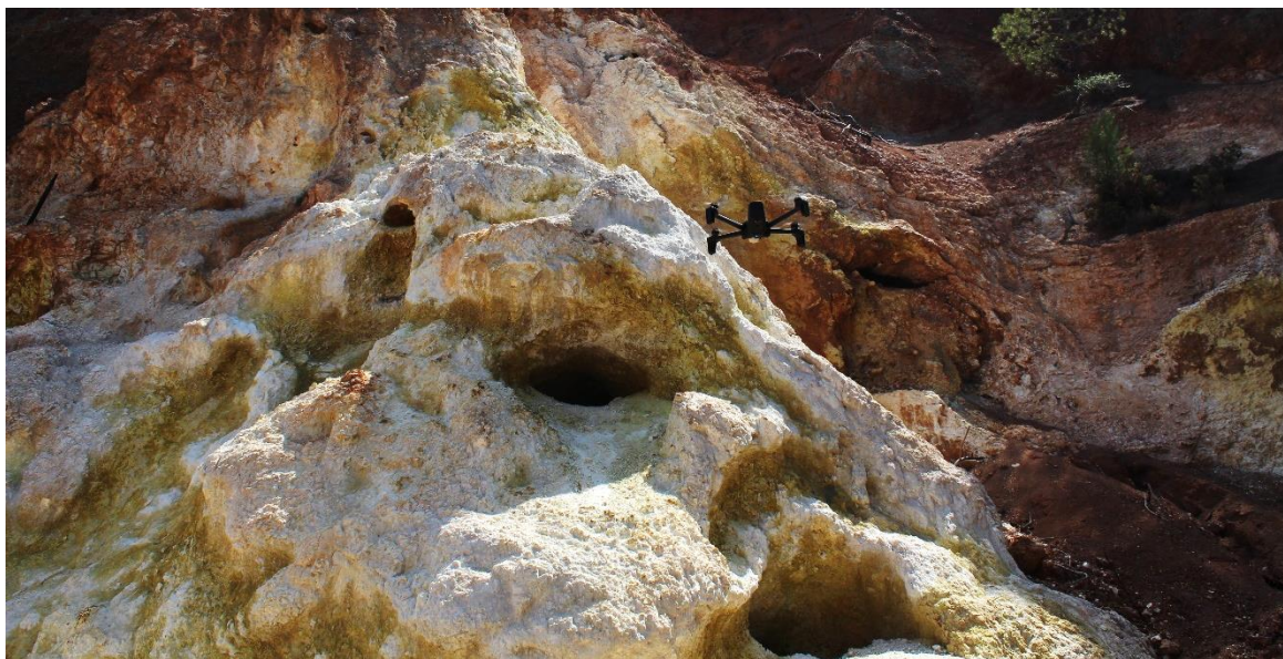
Εικόνα 7 - Αποτύπωση των αρχαίων γαλαριών με τη μέθοδο της φωτογραμμετρίας στην περιοχή Πλαθκειές
